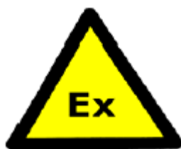
Rys. 1. Oznakowanie przestrzeni zagrożonych wybuchem zgodnie z wytycznymi UE.
